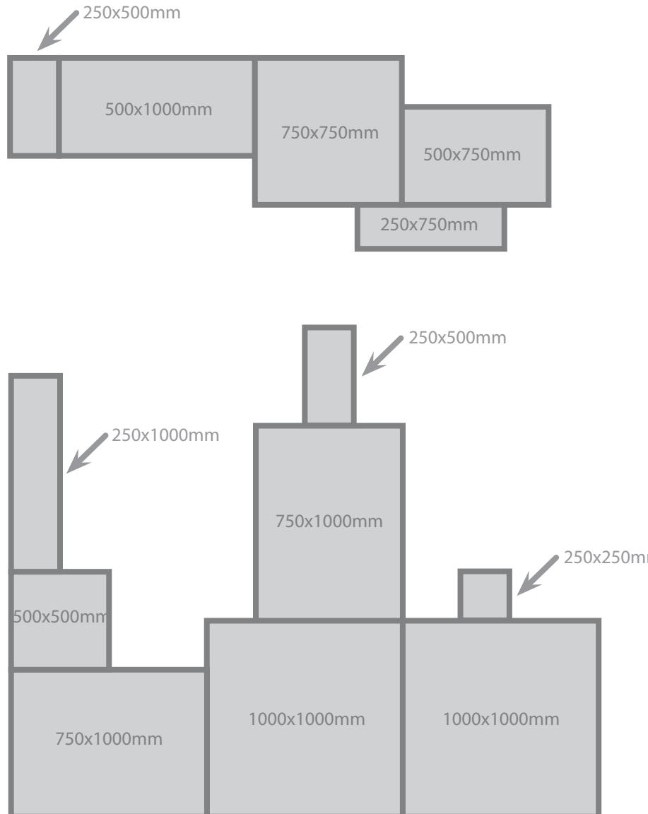
Door het gebruik van het 250 x 250 mm stamien zijn alle modules met elkaar te koppelen. Dit kan met meeleverbare bevestigingsmiddelen, om iedere max. 150mm.
